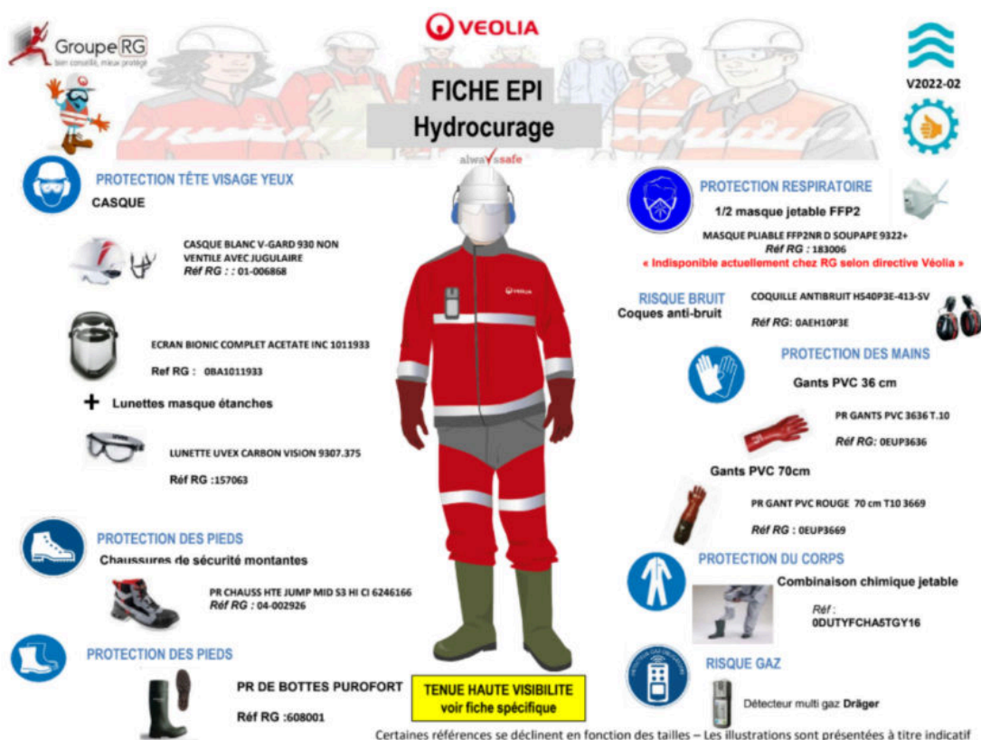
Figure 26. Equipements de protection individuelle portés par les agents en charge des opérateurs d'hydrocurage Source : Veolia (2025)
