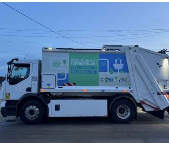
Une des 2 bennes électriques à Ordures Ménagères (BOM)
