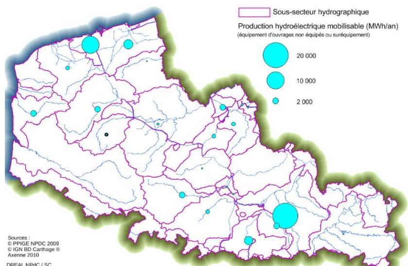
Figure 53 -Gisement régional estimé pour l'installation de microcentrales hydroélectriques (Source : ISL pour l'Agence de l'eau Artois - Picardie (2008))
